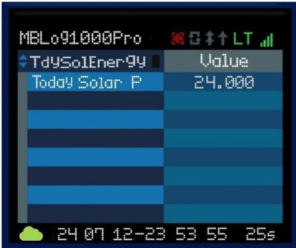
Figure-4.17: Today solar energy parameters display
