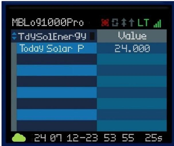
Figure-4.17: Today solar energy parameters display
