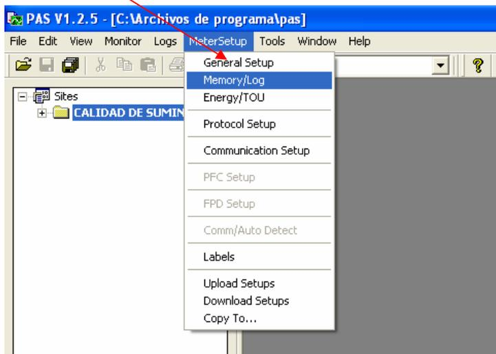
Aquí aparecerá un sub-menú con varias pestañas en las cuales configuraremos todos los parámetros, salvando primero la configuración y luego enviándosela al instrumento mediante el botón “send”, para lo cual debemos estar on-line con el instrumento.
